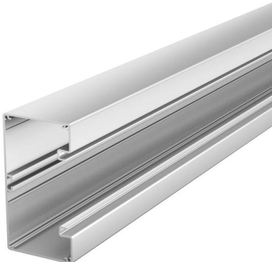
Canale porta apparecchi senza foratura alla base indicato per il montaggio diretto a parete o su mensole. Su richiesta possono essere realizzati anche elementi inferiori e superiori del canale e coperchi con lunghezze extra, fino a 6000 mm, e anche altri colori RAL. Le superfici esterne dei canali porta apparecchi sono limate.
