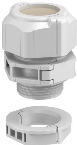
Il pressacavo separabile V-TEC TB... come tutti i pressacavi V-TEC, garantisce un'impermeabilizzazione affidabile dei cavi. L'installazione delle linee funzionali o dei cavi preconfezionati, ad esempio, grazie alla separabilità del pressacavo è facile e rapida.
