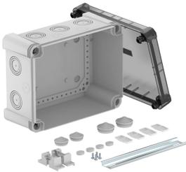
Scatola di derivazione con profilato per il collegamento di cavi e linee in ambienti interni e ambienti esterni. Forma rettangolare con inserti di deviazione. Adatta per il montaggio su pareti e soffitti con la possibilità di fissaggio esterno e interno o il montaggio su sezioni angolari. Resistente agli urti IK09. Coperchio trasparente con chiusura rapida, piombabile. Costruito con materiali privi di alogeni e resistenti ai raggi UV. Include profilato tipo 2069.
