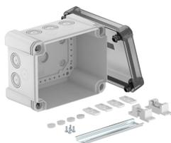
Scatola di derivazione con profilato per il collegamento di cavi e linee in ambienti interni e ambienti esterni. Forma rettangolare con inserti di deviazione. Adatta per il montaggio su pareti e soffitti con la possibilità di fissaggio esterno e interno o il montaggio su sezioni angolari. Resistente agli urti IK09. Coperchio trasparente con chiusura rapida, piombabile. Costruito con materiali privi di alogeni e resistenti ai raggi UV. Include profilato tipo 2069.
