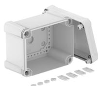
Scatola di derivazione per il collegamento di cavi e linee in ambienti interni e ambienti esterni. Forma rettangolare senza ingressi. Adatta per il montaggio su pareti e soffitti con la possibilità di fissaggio esterno e interno o il montaggio su sezioni angolari. Resistente agli urti IK09. Coperchio con chiusura rapida, piombabile. Costruito con materiali privi di alogeni e resistenti ai raggi UV.
