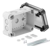
Scatola di derivazione con profilato per il collegamento di cavi e linee in ambienti interni e ambienti esterni. Forma rettangolare con inserti di deviazione. Adatta per il montaggio su pareti e soffitti con la possibilità di fissaggio esterno e interno o il montaggio su sezioni angolari. Resistente agli urti IK09. Coperchio trasparente con chiusura rapida, piombabile. Costruito con materiali privi di alogeni e resistenti ai raggi UV. Include profilato tipo 2069.
