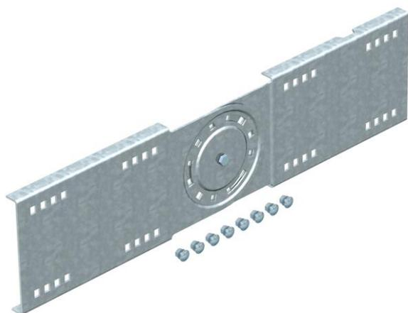
Connettore regolabile per il fissaggio di passerelle a grande portata dei tipi WKSG e WKLK con bordo di altezza pari a 160 mm. Inclusive viti, rondelle e dadi.
