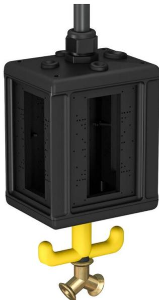
HoverCube non equipaggiato, con 1 m di tubo da 1/2" e raccordo per tubo flessibile dell'aria compressa da 13 x 3,5 mm e ripartitore a 2 vie da 1/2". Con occhio di sospensione e maniglia a gancio. Equipaggiabile sui tutti e 4 i lati. Coperchi di chiusura non inclusi nella fornitura. Per utilizzo in ambienti umidi. Grado di protezione: IP44.
