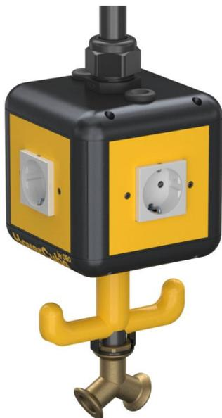
Alloggiamento equipaggiato e precablato con 1 m di tubo da 1/2" e raccordo per tubo flessibile dell'aria compressa da 13 x 3,5 mm e ripartitore a 2 vie da 1/2", con occhiello di aggancio, maniglia a gancio e 4 piastre di copertura.
