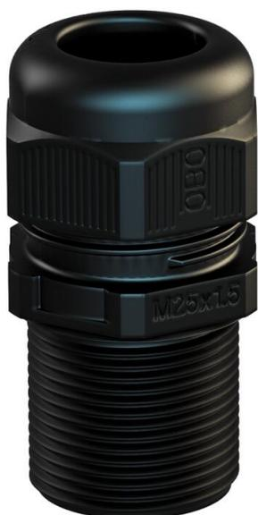
Pressacavo con filettatura metrica, adatto per scatole di derivazione, per applicazioni residenziali ed industriali. Con scarico della trazione e guarnizione di tenuta integrata, testato secondo norma CEI EN 62444. Grado di protezione IP68. Range temperatura -20°C a +65°C.
