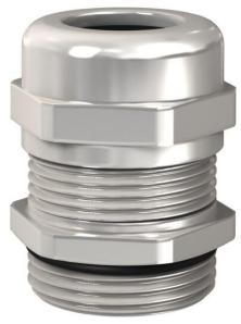
Pressacavo EMC con filettatura di raccordo metrica, dotato di dado cieco, secondo IEC 423. Scarico di trazione, protezione antitorsione e tenuta sull'intero campo di serraggio. Guarnizione in neoprene. Inserto di fissaggio in poliammide.
