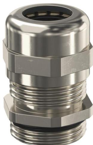
Pressacavo con filettatura di raccordo metrica, dotato di dado cieco, secondo IEC 423. Scarico di trazione, protezione antitorsione e tenuta sull'intero campo di serraggio. Guarnizione in neoprene. Inserto di fissaggio in poliammide.
