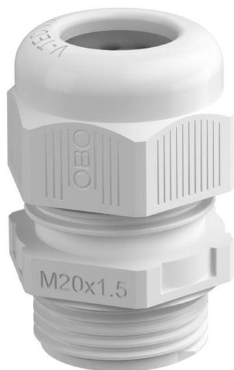
Pressacavo con filettatura metrica, adatto per scatole di derivazione, per applicazioni residenziali ed industriali. Con scarico della trazione e guarnizione di tenuta integrata, testato secondo norma CEI EN 62444. Grado di protezione IP68. Range temperatura -20°C a +65°C.
