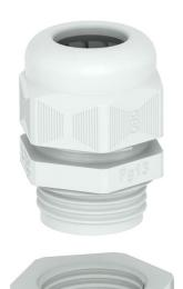
Pressacavo con filettatura PG, adatto per scatole di derivazione, per applicazioni residenziali ed industriali. Con scarico della trazione e guarnizione di tenuta integrata, testato secondo norma CEI EN 62444. Grado di protezione IP68. Range temperatura -20°C a +65°C. Controdado incluso.
