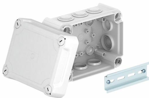
Scatola di derivazione per il collegamento di cavi e linee in ambienti interni e ambienti esterni protetti. Forma rettangolare con passacavi sui lati e inserti nel fondo. Adatta per il montaggio su pareti e soffitti e il montaggio su piastre di montaggio. Con la possibilità di fissaggio interno e montaggio tramite cupole angolari. Coperchio alto con chiusura rapida, piombabile. Costruito con materiali privi di alogeni e resistenti ai raggi UV. Con guida profilata DIN.
