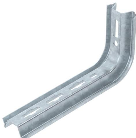
Mensola a parete TP per il fissaggio a soffitti in calcestruzzo orizzontali o pareti. Se il profilato viene fissato al soffitto o se viene avvitato con un altro profilato per il rinforzo delle estremità è necessario utilizzare sempre il distanziatore tipo DS 4 per garantire maggiore stabilità.
