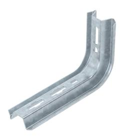
Mensola a parete TP per il fissaggio a soffitti in calcestruzzo orizzontali o pareti. Se il profilato viene fissato al soffitto o se viene avvitato con un altro profilato per il rinforzo delle estremità è necessario utilizzare sempre il distanziatore tipo DS 4 per garantire maggiore stabilità.
