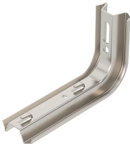
Mensola a parete TP per il fissaggio rapido senza viti della passerella grigliata. Se il profilato viene fissato al soffitto o se viene avvitato con un altro profilato per il rinforzo delle estremità è necessario utilizzare sempre il distanziatore tipo DS 4 per garantire maggiore stabilità.
