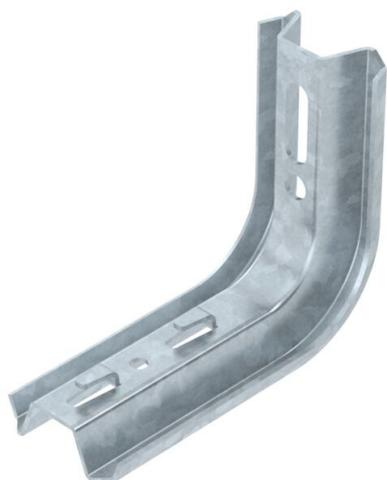
Mensola a parete TP per il fissaggio rapido senza viti della passerella grigliata. Se il profilato viene fissato al soffitto o se viene avvitato con un altro profilato per il rinforzo delle estremità è necessario utilizzare sempre il distanziatore tipo DS 4 per garantire maggiore stabilità.
