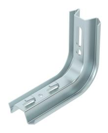
Mensola a parete TP per il fissaggio rapido senza viti della passerella grigliata. Se il profilato viene fissato al soffitto o se viene avvitato con un altro profilato per il rinforzo delle estremità è necessario utilizzare sempre il distanziatore tipo DS 4 per garantire maggiore stabilità. Sulla mensola TP possono essere fissate senza viti passerelle a filo con larghez-
