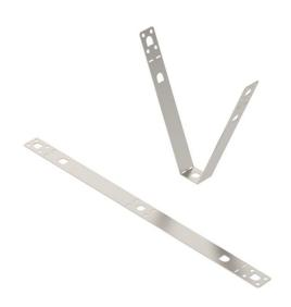
Fissaggio trapezoidale per la sospensione di sistemi portacavi di soffitti trapezoidali standard. Larghezza profilo trapezoidale fino a 165 mm. Montaggio con perno tipo TPB R o vite a testa esagonale tipo SKS 10x110. Il materiale di fissaggio deve essere ordinato separatamente.
