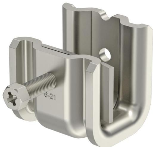
Questo tipo di graffe di supporto viene spinto sulle travi e fissato con coppa e vite (M8) alla trave o ai profilati piatti. La vite a testa esagonale ha un'apertura di chiave di 10 mm. Nella fascetta sono inoltre presenti due altre filettature M8, per fissare per esempio delle aste filettate.
