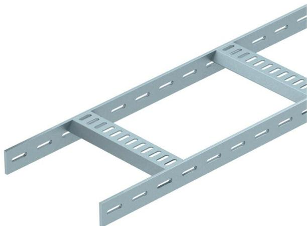
Passerella per impianti navali con longherone laterale asolato con bordo di altezza pari a 40 mm con pioli trapezoidali saldati, forati, aperti verso il basso. Carico testato secondo IEC in combinazione con connettore tipo SLV.
