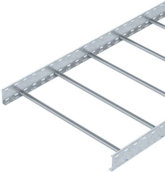
Passerella a traversini con bordo di altezza pari a 110 mm saldata, con pioli del profilato a C30 con scanalatura verso l'alto. Longherone laterale arrotondato come rinforzo e protezione dei bordi. Il fissaggio alla mensola viene eseguito con morsetti tipo LKS 40. La misura della scanalatura del piolo è pari a 16,5 mm, la staffa reggicavo è il tipo 2056. Schermatura elettromagnetica senza coperchio 10 dB, con coperchio 15 dB.
