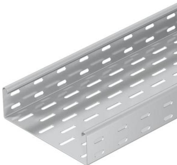
SKS 60 = sistema di passerelle pesanti con bordo di altezza pari a 60 mm. La passerella portacavi tipo SKS può essere utilizzata anche per il mantenimento funzionale. Per ulteriori informazioni vedere i sistemi di protezione antincendio BSS. La passerella portacavi viene fissata alla mensola con viti tipo FRS M6 x 12. Schermatura magnetica senza coperchio 20 dB, con coperchio 50 dB.
