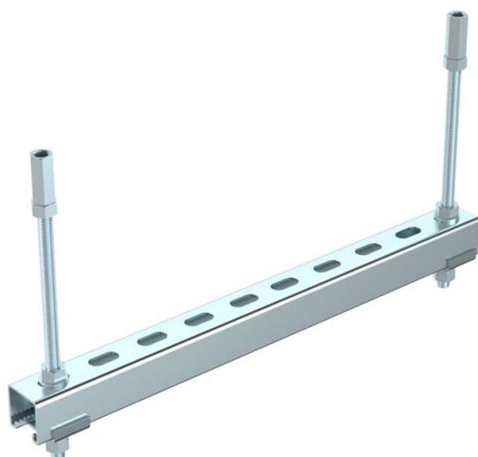
Materiale di sospensione e fissaggio in acciaio per la realizzazione del primo supporto delle installazioni eseguite con isolamenti antincendio. Montaggio del pendolo con aste filettate a soffitto. È possibile montare max due posizioni con manicotti di collegamento di due set. Le strutture di supporto devono essere disposte su entrambi i lati della parete alla distanza prescritta dal sistema di isolamento.
