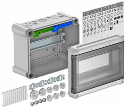
Distributore piccolo con morsettiera per montaggio a parete, per sottoquadro distribuzione corrente in ambienti interni ed esterni, secondo IEC 439-3. Con profilo di sospensione premontato 35 mm. Tipo di protezione IP66 e grado di protezione IK06. Coperchio trasparente avvitabile, con intaglio
