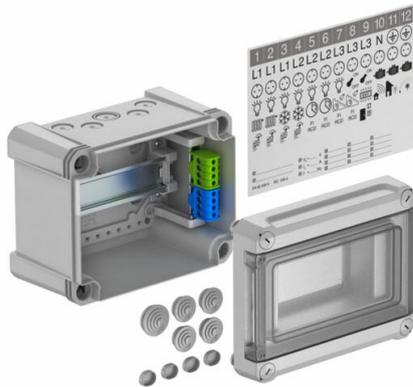
Distributore piccolo con morsettiera per montaggio a parete, per sottoquadro distribuzione corrente in ambienti interni e ambienti esterni protetti, secondo IEC 439-3. Con profilato di sospensione premontato 35 mm. Tipo di protezione IP66 e grado di protezione IK06. Coperchio trasparente avvitabile, con intaglio
