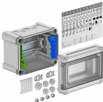
Distributore piccolo con morsettiera per montaggio a parete, per sottoquadro distribuzione corrente in ambienti interni ed esterni, secondo IEC 439-3. Con profilo di sospensione premontato 35 mm. Tipo di protezione IP66 e grado di protezione IK06. Coperchio trasparente avvitabile, con intaglio
