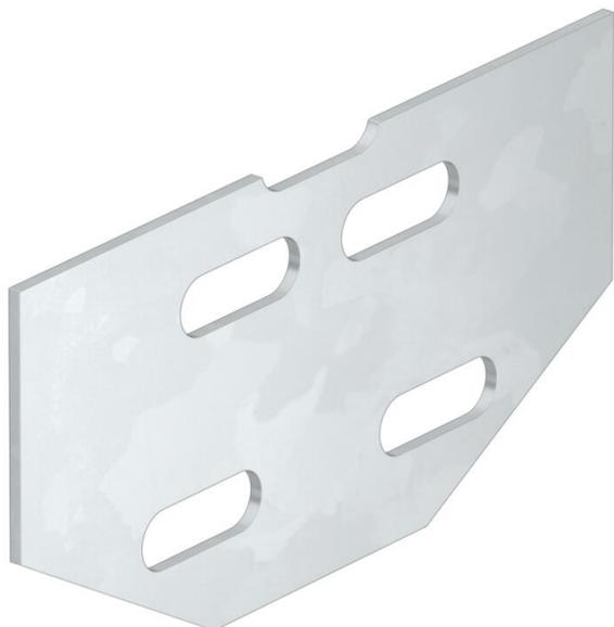
Il giunto longitudinale verticale può essere usato per il collegamento longitudinale di passerelle portacavi con altezza del bordo di 60 mm. Con questo connettore è possibile realizzare giunti ad angolo in salita e discesa fino ad un angolo di 60°. La continuità elettrica è assicurata attraverso il morsetto.
