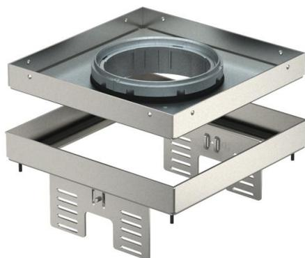
Cassetta livellabile quadrata, dimensione nominale 4, con uscita cavi con tubo telescopico adatta per pavimenti trattati a lavaggio secco.
