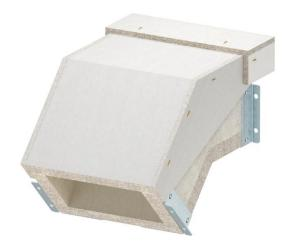
Curva verticale in discesa per canale antincendio PYROLINE® Con S El60, tipo PLCS D061220 in calcestruzzo leggero con fibra di vetro resistente all'acqua e al gelo per realizzare variazioni di direzione verticali (45°) nello sviluppo del canale. I materiali di collegamento consentono un rapido montaggio, i coperchi consentono una rapida ispezione e successiva implementazione.
