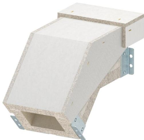
Curva verticale in discesa per canale antincendio PYROLINE® Con S EI60, tipo PLCS D060810 in calcestruzzo leggero con fibra di vetro resistente all'acqua e al gelo per realizzare variazioni di direzione verticali (45°) nello sviluppo del canale. I materiali di collegamento consentono un rapido montaggio, i coperchi consentono una rapida ispezione e successiva implementazione.
