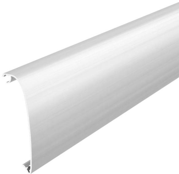
Coperchio canale per la creazione di un canale porta apparecchi design della serie GAD. Versione design "Soft" per la copertura completa dell'apertura sistema e dei dispositivi di commutazione e connessione. Gli adattatori del coperchio GAD OT sono assolutamente necessari e dovrebbero essere progettati ad una distanza max. di 50 cm sul tratto del canale. Tra le copertura canali deve essere installato un distanziatore GAD OTD.
