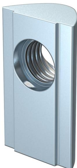
Dado scanalato con filettatura M8 per il montaggio di estensioni ed accessori. Un elemento di pressione della parte inferiore permette al blocco di attaccarsi alla scanalatura. Sicurezza antitorsione automatica tramite la profilatura della parte superiore.
