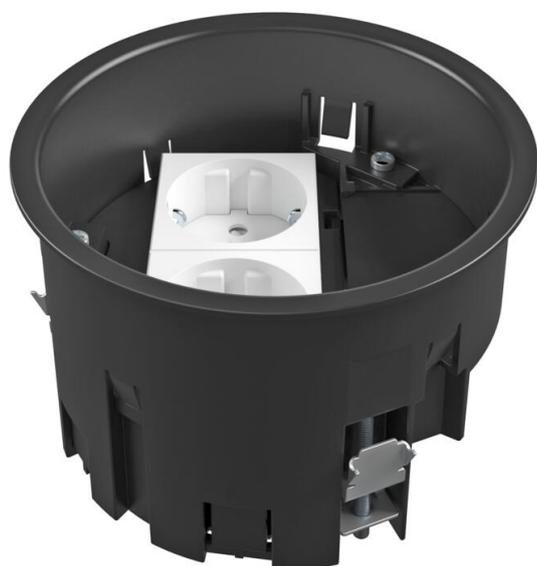
Scatola di installazione adatta per torretta GES R2 per il montaggio in scatola per massetto UD GES R2 o per pavimenti sopraelevati (con alette di fissaggio).
