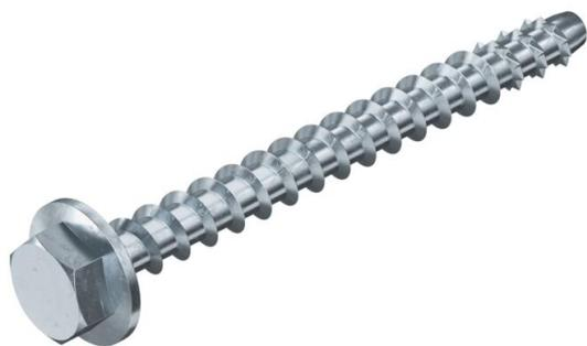
Vite ancoraggio per il montaggio diretto senza tassello in calcestruzzo fessurato e non, nonché muratura. Con intaglio esagonale e rondella a pressione per grandi carichi. Idoneo per il fissaggio di profilati di sospensione e mensole a parete in ambienti umidi ed esterni.
