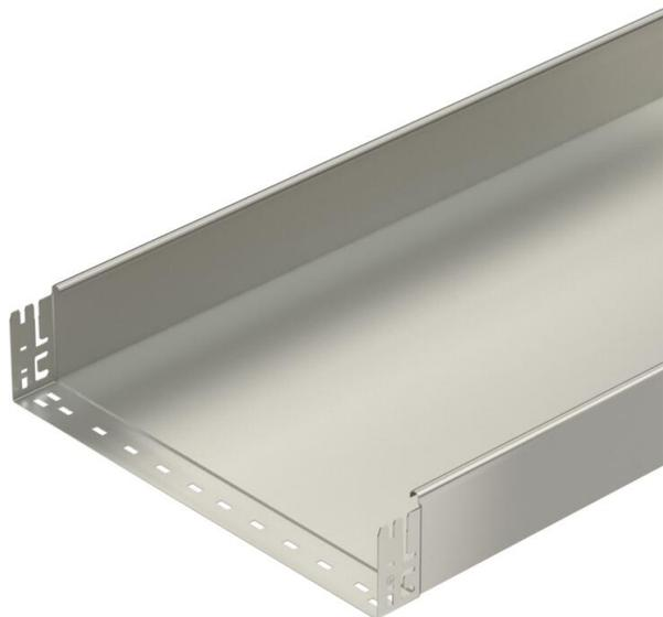
Passerella chiusa con sistema di fissaggio rapido integrato. La lunghezza utile della passerella è di 3.000 mm. Il collegamento equipotenziale continuo è garantito senza componenti aggiuntivi.
