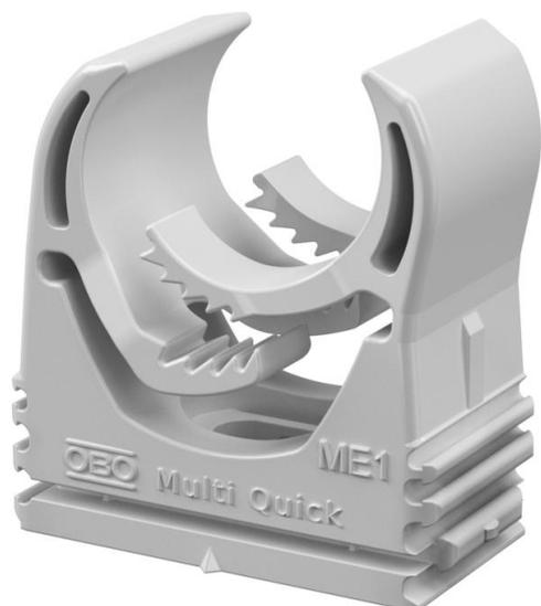
Gaffetta per l'alloggiamento di tubi in acciaio metrici e PG, tubi isolanti leggeri/pesanti e tubi plastici della serie Quick. Range di serraggio variabile. Possibilità di fissaggio universale su pareti e soffitti in ambienti interni ed esterni protetti. Montaggio dei tubi senza l'ausilio di attrezzi. Possibilità di montaggio anche con gaffette OBO Quick o starQuick.
