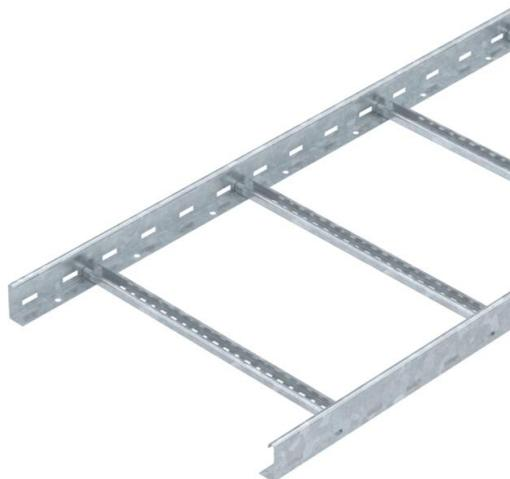
Passerella a travesini con longherone forato, con bordo di altezza pari a 60 mm, pioli del profilato a C rivettati e aperti verso l'alto (versione VS). La passerella a travesini viene fornita in versione ripiegata.
