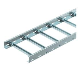
Passerella per la posa orizzontale di cavi. Utilizzabile come costruzione di supporto standard per il mantenimento funzionale secondo DIN 4102 parte 12. Classe di mantenimento funzionale da E30 a E90. Con piolo a C rivettato aperto ver-
