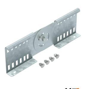
Connettore regolabile esterno per il fissaggio di passerelle e accessori con bordo di altezza pari a 110 mm e longherone forato. Angolo regolabile in verticale. La continuità elettrica è assicurata attraverso il connettore.
