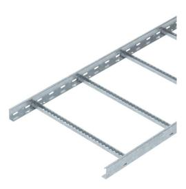
Passerella a traversini con bordo di altezza pari a 60 mm, con pioli del profilato C30 aperti verso l'alto saldati. Longherone laterale arrotondato come rinforzo e protezione dei bordi. Il fissaggio alla mensola viene eseguito con morsetti tipo LKS 40. La misura della scanalatura del piolo è pari a 16,5 mm, la staffa reggicavo è il tipo 2056.
