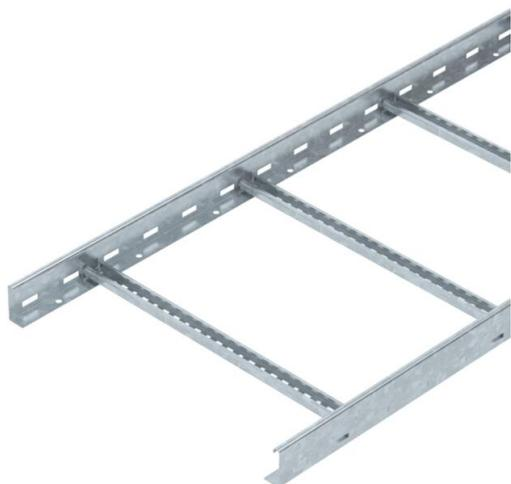
Passerella a traversini con bordo di altezza pari a 60 mm, con pioli del profilato C30 aperti verso l'alto saldati. Longherone laterale arrotondato come rinforzo e protezione dei bordi. Il fissaggio alla mensola viene eseguito con morsetti tipo LKS 40. La misura della scanalatura del piolo è pari a 16,5 mm, la staffa reggicavo è il tipo 2056. Schermatura elettromagnetica senza coperchio 10 dB, con coperchio 15 dB.
