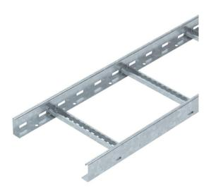
Passerella a traversini con bordo di altezza pari a 60 mm, con pioli del profilato C30 aperti verso l'alto saldati. Longherone laterale arrotondato come rinforzo e protezione dei bordi. Il fissaggio alla mensola viene eseguito con morsetti tipo LKS 40. La misura della scanalatura del piolo è pari a 16,5 mm, la staffa reggicavo è il tipo 2056.
