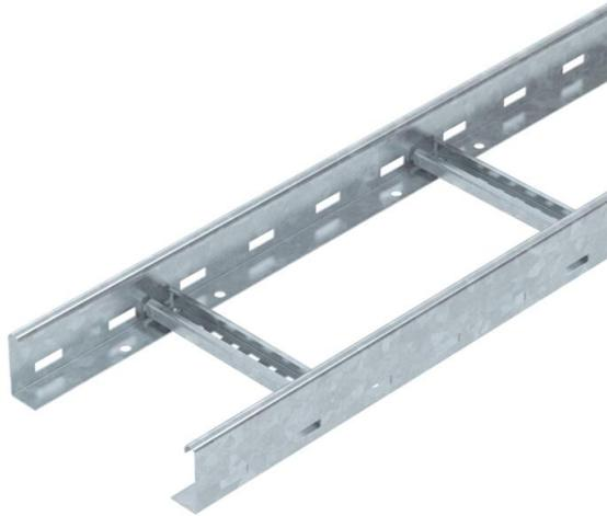
Passerella a traversini con bordo di altezza pari a 60 mm, con pioli del profilato C30 aperti verso l'alto saldati. Longherone laterale arrotondato come rinforzo e protezione dei bordi. Il fissaggio alla mensola viene eseguito con morsetti tipo LKS 40. La misura della scanalatura del piolo è pari a 16,5 mm, la staffa reggicavo è il tipo 2056. Schermatura elettromagnetica senza coperchio 10 dB, con coperchio 15 dB.
