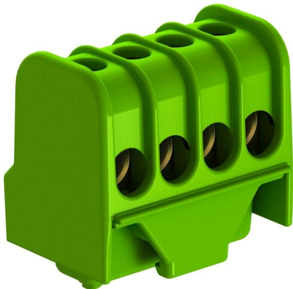
Morsetto di collegamento con conduttore di protezione, morsettiera in ottone, viti in acciaio, zincato galvanicamente e passivato trasparente, sezione nominale 6 + 16 mm<sup>2</sup>, tensione nominale 400 V, 1 polo, con morsetti a bussola, numero massimo di conduttori collegabili per punto di bloccaggio: max. 4x16 mm<sup>2</sup>, 4x10 mm<sup>2</sup>, 8x6 mm<sup>2</sup> o 12x4 mm<sup>2</sup>.
