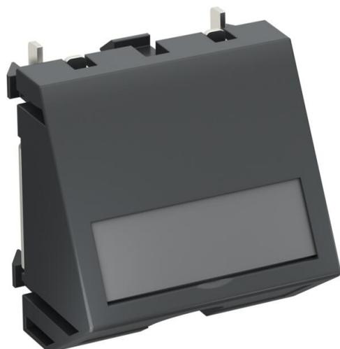
Uscita cavo in 2 parti con campo di siglatura, costituita da un supporto cavi con scarico trazione e una copertura. Lo scarico trazione è progettato per cavi con diametro di 3-11 mm. Il fissaggio a incastro è adatto per l'incasso orizzontale e verticale dei dispositivi.
