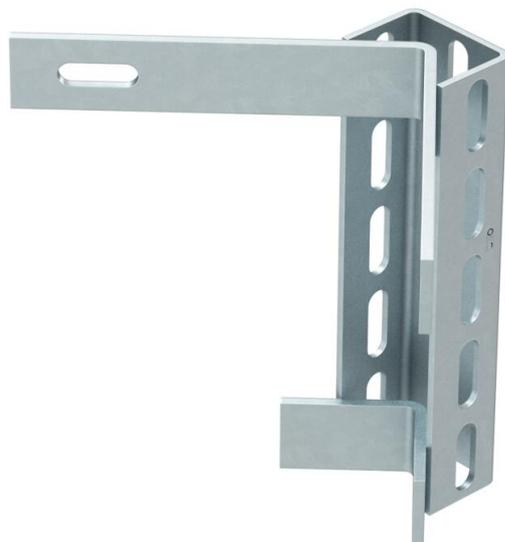
Supporto angolare con profilo a U saldato per il fissaggio all'angolo esterno di 90°. Al profilo a U vengono avvitate le mensole a parete e a profilato.
