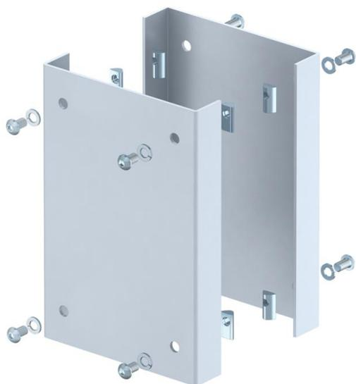
Protezione antiurto della colonna industriale ISS nell'area del pavimento. Nella fornitura sono compresi 2 profili di protezione a U in lamiera d'acciaio da 3 mm e 8 viti di fissaggio con dadi scanalati per il montaggio sul profilo della colonna.
